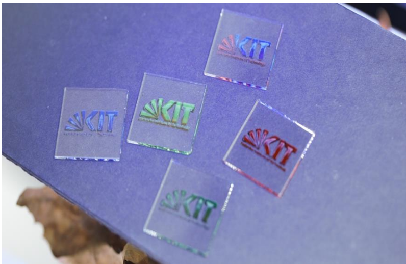
Gedruckte farbige Perowskit-Solarzellen in Form des Logos des KIT. (Foto: IMT/KIT)
