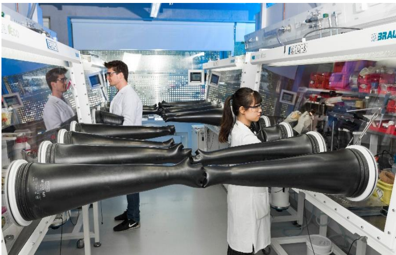
Forschende am HIU montieren Magnesiumbatterien unter Argon-Schutzgas. (Foto: Laila Tkotz/KIT)
