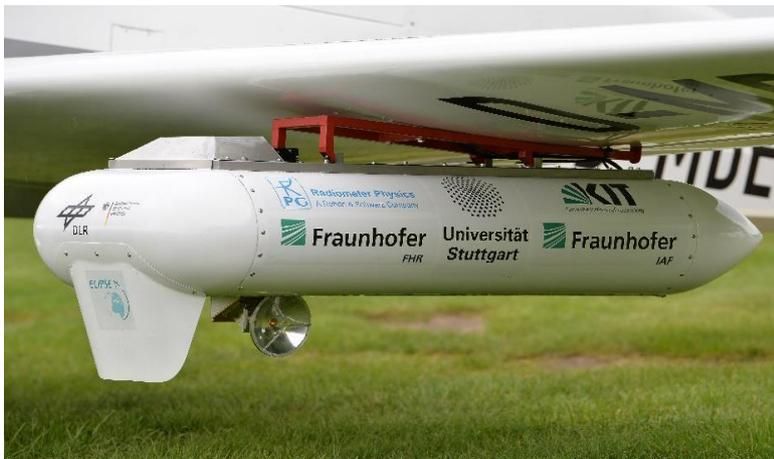
Sender am Flügel des Flugzeugs. Eine kleine Parabolantenne sorgt für die korrekte Ausrichtung auf die Bodenstation. Foto: R. Sommer/ Fraunhofer FHR
