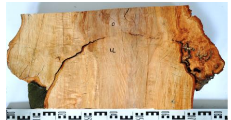
Bei dem getrockneten Längsschnitt durch eine veredelte Blutbuche zeigen die Trocknungsrisse entlang der Verwachsungsnaht das Risiko an. (Foto: KIT)
