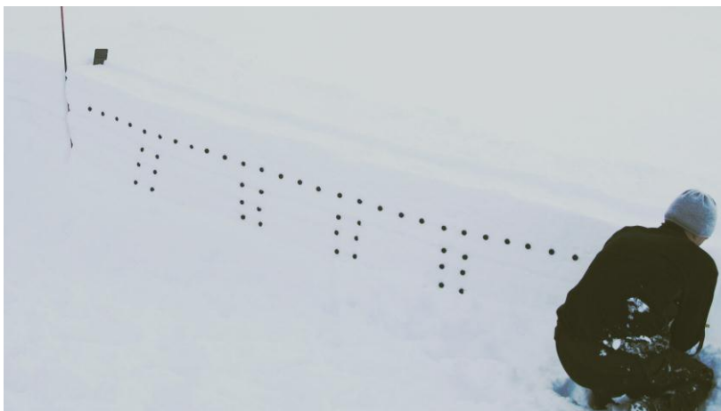
Lawinenauslösung im Schneeblock: Beschleunigungssensoren in der Schneedecke messen die Bruchgeschwindigkeit. (Foto: A. van Herwijnen)
