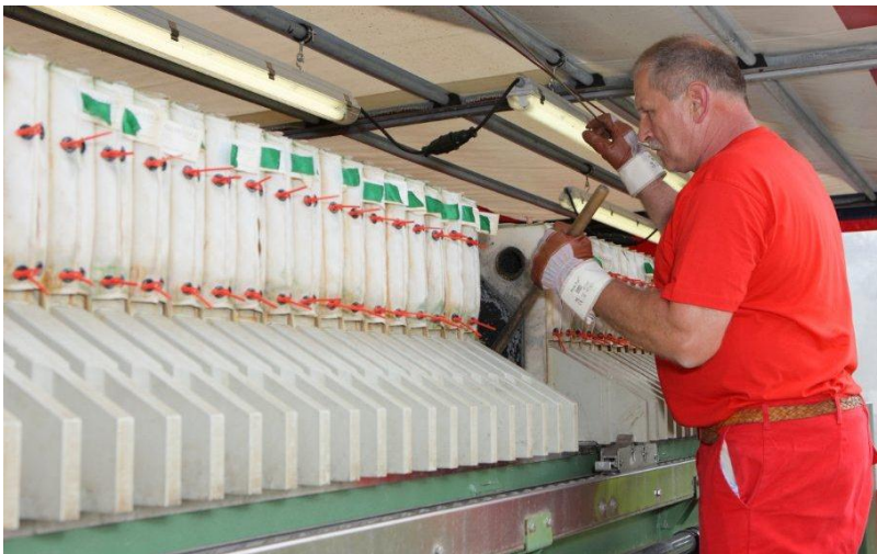
Fortschritt: KIT-Wissenschaftler ergänzen mobile Anlagen zur Schlammmentwässerung mit ihrem Verfahren zur Phosphor-Rückgewinnung. (Foto: MSE)
