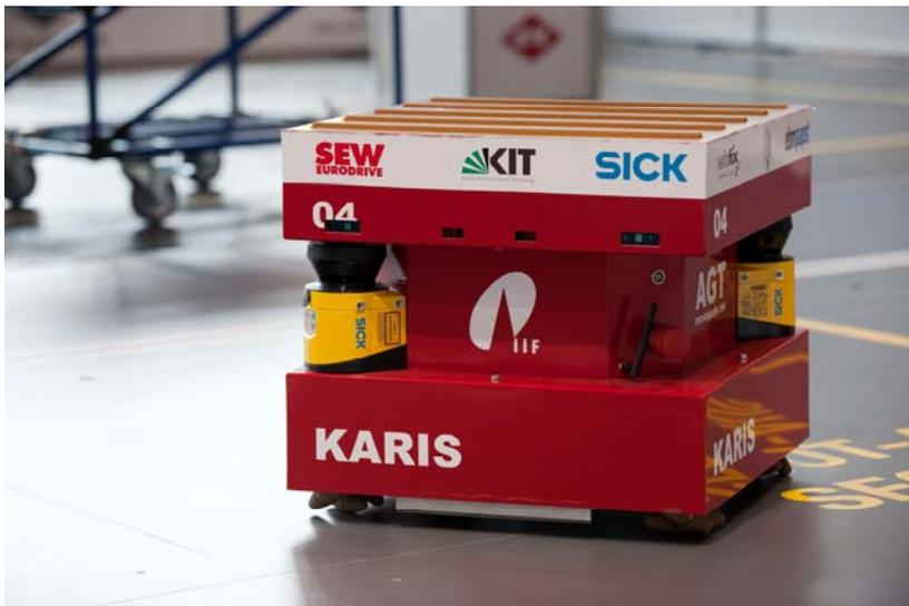
KARIS – autonome Elemente optimieren den Materialfluss in Warenlagern und Fertigungshallen (Foto: KIT)
