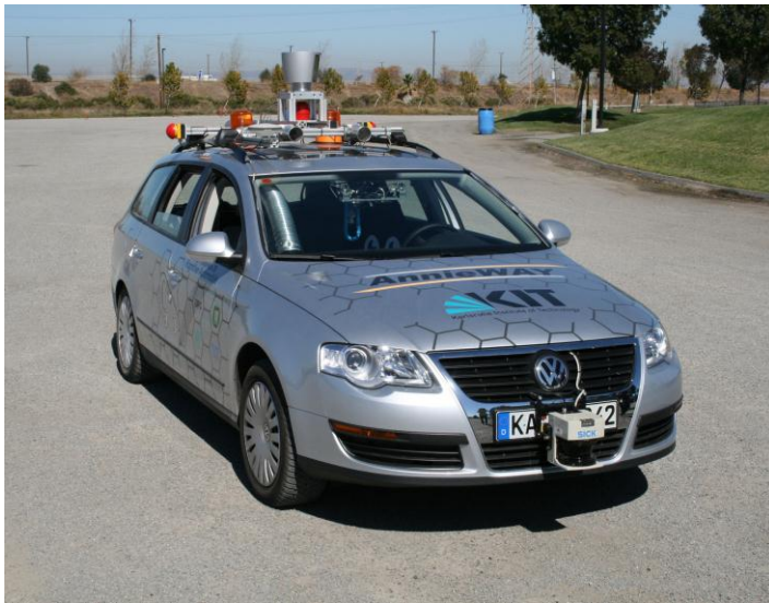
Mit Sensoren und Computern ausgestattet findet AnnieWAY selbstständig seinen Weg im Straßenverkehr. (Bild: Institut für Mess- und Regelungstechnik, KIT)
