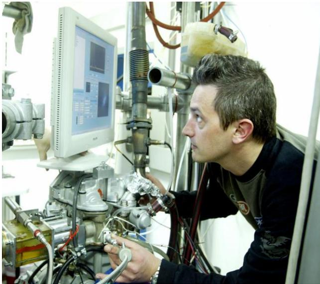
Verbrennungsanalyse am Einzylindermotor mit faseroptischer Endoskopie.
