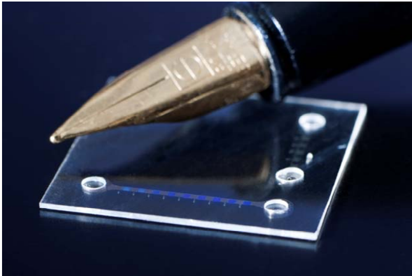
Ultraflacher Flüssigkeits-Farbstofflaser: Der nanostrukturierte Boden des 0,5 Millimeter breiten und 1,6 Mikrometer hohen Mikrokanals beugt blaues Licht in Richtung des Beobachters. (Foto: KIT)
