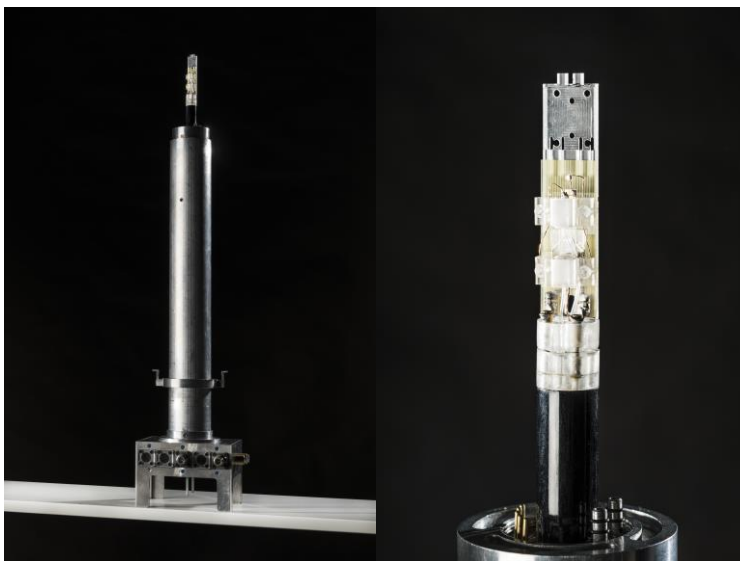
NMR-Probenkopf (links) mit miniaturisiertem Detektor (rechts). In HiSCORE werden solche Detektoren mit leistungsfähiger Hyperpolarisation kombiniert, um das Bindungsgeschehen von Wirkstoffkandidaten zu erfassen. (Fotos: Markus Breig, KIT)
