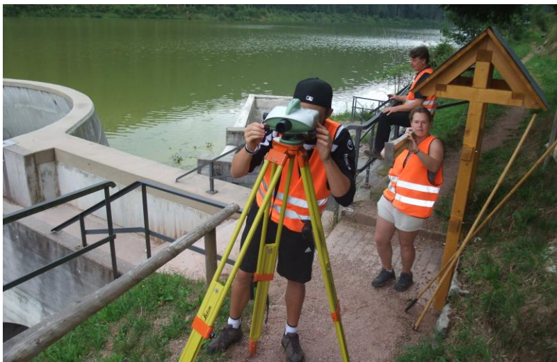
Feinnivellement – hochpräzises Messen von Höhenunterschieden – an der Linachtalsperre (Foto: GIK)
