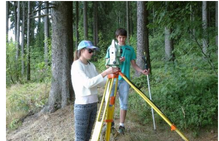
Tachymetrie: Richtungs- und Entfernungsmessung (Foto: GIK)
