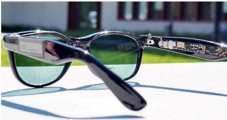
*Die Solarbrille versorgt mit halbtransparenten organischen Solarzellen als Brillengläsern zwei Sensoren und Elektronik im Bügel mit Strom. (Bild: KIT)*
