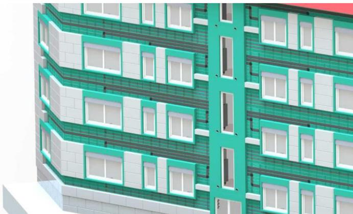
*Fassadenelemente, die nicht nur die Wärmedämmung sondern auch Komponenten der Heizungs- und Lüftungstechnik enthalten, sind ein Thema bei LowEx-Bestand. (Bild: Fraunhofer ISE)*
