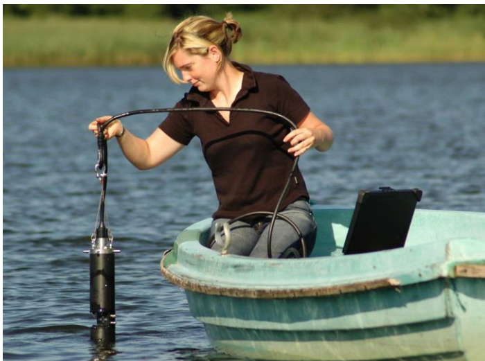
Derzeitige Einsatzmethode des Multialgensensors – künftig wird sie im Verbund mit weiteren Sensoren automatisiert von Bojen aus betrieben. (Foto: bbe Moldaenke GmbH)
