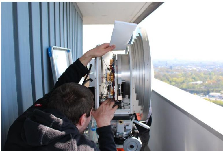
E-Band-Sender mit Parabolantenne. Die darin verbauten integrierten Schaltungen weisen besonders große Leistungsfähigkeit auf. (Foto: Jörg Eisenbeis, KIT)
