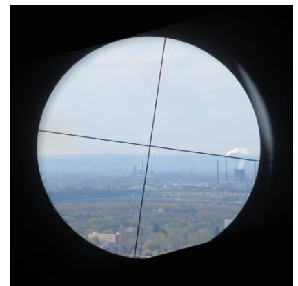
Sichtpeilung ausgehend vom Sender auf dem Uni-Center Köln zum Radom des Fraunhofer FHR in Wachtberg (als Kuppel am Horizont rechts unter dem Kreuz erkennbar). (Foto: Jörg Eisenbeis, KIT)
