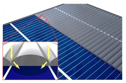
Eine spezielle Tarnkappen-Beschichtung (rechts) leitet Sonnenlicht an den Kontakten für die Stromableitung vorbei, auf die aktive Fläche der Solarzelle. (Grafik: Martin Schumann, KIT)
