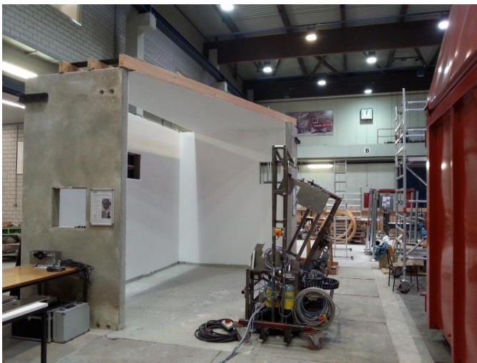
Das System MAFRO misst selbstständig die radioaktive Belastung von Oberflächen, dekontaminiert und misst erneut für die Freigabe der Oberfläche. (Foto: Patrick Kern, KIT)
