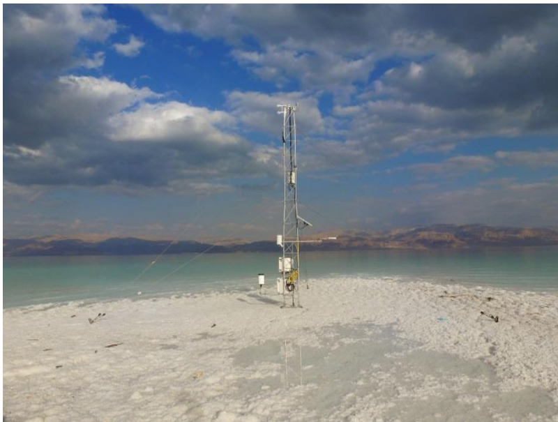
Die tiefstgelegene meteorologische Messstation der Erde: Direkt am Toten Meer steht ein sechs Meter hoher Messmast. Die Instrumente messen Strahlung, Verdunstung und Wärme. (Foto: Dr. Ulrich Corsmeier)
