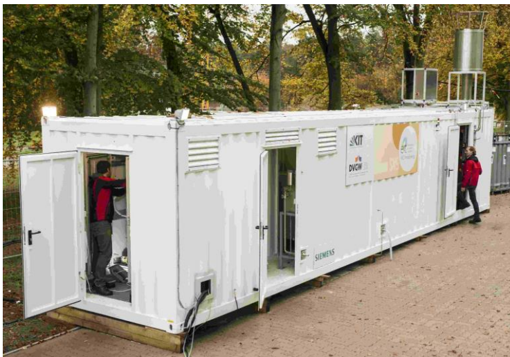
Die Pilotanlage DemoSNG passt in einen handelsüblichen Frachtcontainer. Sie ist mobil und dezentral einsetzbar. (Bild: KIT)
