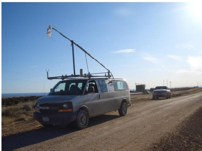
Das KIT-Messgerät an Bord eines Minivans ermöglicht es, atmosphärische Emissionen direkt vor Ort und mit hoher zeitlicher Auflösung zu vermessen. (Bild: F. Geiger/KIT)
