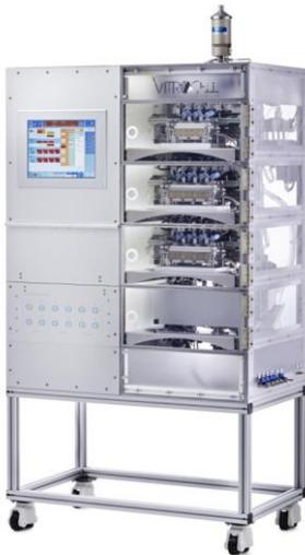
Das Karlsruher Expositionssystem ist kompakt und kann auch Feinstaubbelastungen am Ort der Belastung messen. (Bild: VITROCELL Systems GmbH)
