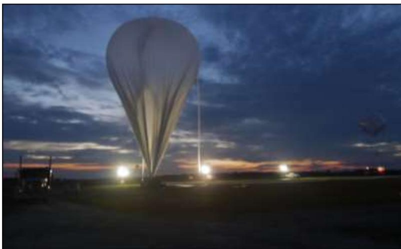
*Der Ballon am Start. In der Gondel sind drei komplexe Fernerkundungsinstrumente, die einen breiten Teil des elektromagnetischen Spektrums abdecken (Foto: Hermann Oelhaf, KIT)*
