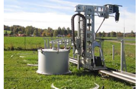
Robotik-Anlage des IMK-IFU zur Messung von Treibhausgas Emissionen (Foto: Dr. Eugenio Diaz-Pines)
