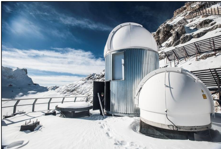
LIDAR-Teleskoptürme: Das am Schneefernerhaus installierte LIDAR (Light Detection And Ranging)-System misst die vertikale Verteilung von Wasserdampf in der Atmosphäre. (Foto: Markus Breig)
