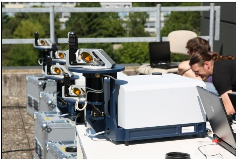
Vorbereitende Vergleichsmessungen mit mehreren Fourierspektrometern auf der Dachterrasse des KIT-Instituts für Meteorologie und Klimaforschung. (Foto: Dr. Frank Hase)
