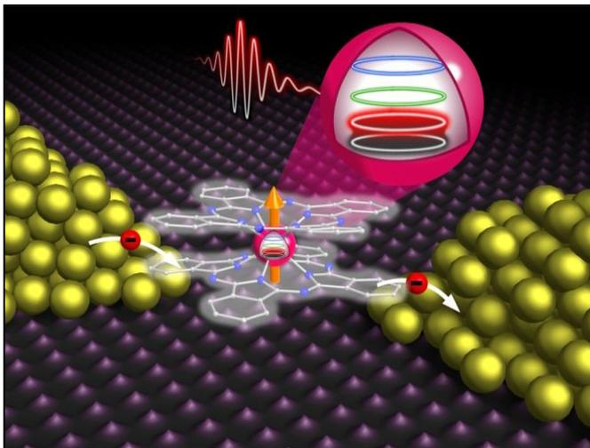
*Einzelmolekül-Magnet, bestehend aus einem Metallion und kontaktierenden organischen Molekülen, zwischen Elektroden. Die Kernspinzustände (farbige Kreise) lassen sich elektrisch manipulieren und auslesen. (Abbildung: C. Grupe, KIT)*
