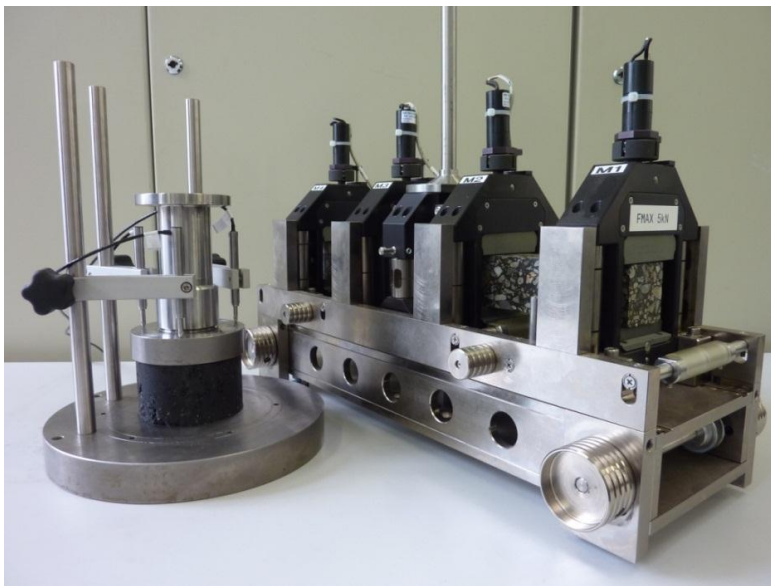
Hightech-Prüfeinsätze zum Ermitteln der Performance von Asphalten am Institut für Straßen- und Eisenbahnwesen. (Foto: Carsten Karcher)
