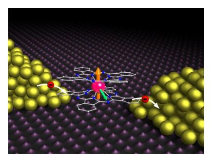
Mittels Goldelektroden kontaktiertes TbPc<sub>2</sub>-Molekül: Elektronen (rot) hüpfen auf das Molekül und lesen Elektronenspin (orange) und Kernspin (grün) des Terbiums aus. (Grafik: C. Grupe, KIT)
